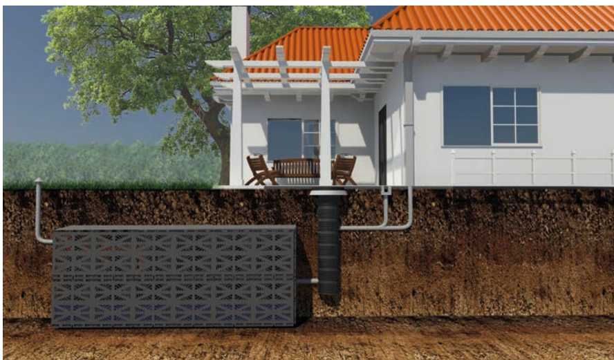
Durchflussregelung (Verzögerung der Regenwasserableitung)
